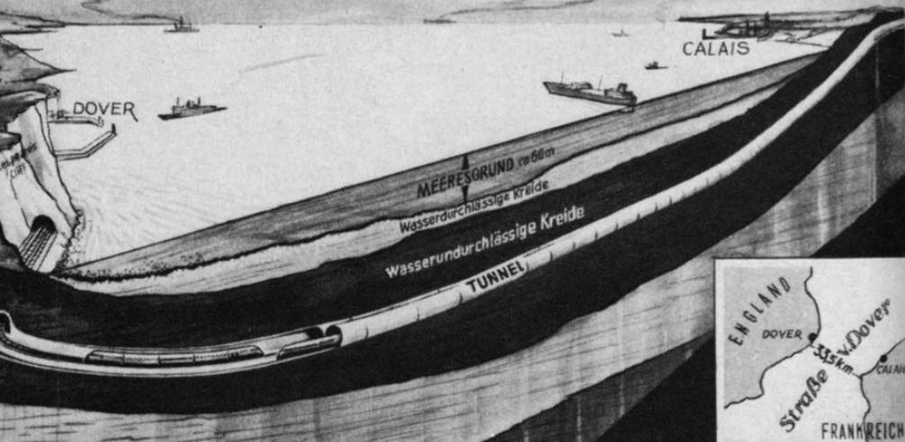
Abb. 26: Schemabild eines Querschnittes durch den Kanal zwischen Calais und Dover mit eingezeichnetem Plan für die Untertunnelung (nach Manfred Sack in der Bildbeilage zu „Die Zeit“, Nr. 15/1960)
